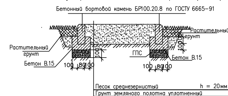
Деталь устройства песчаного покрытия (Тип 2)
